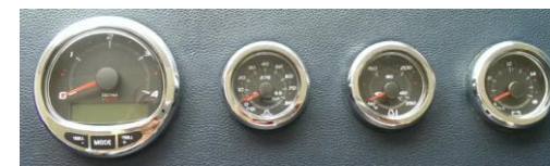
引擎儀表：轉速、水溫、油壓、 電瓶電壓
